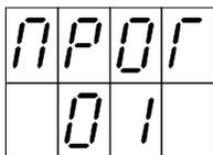
Кнопками “ + ” и “ - ” можно изменить номер программы, после чего контроллер начнет выполнять новую программу, установив предварительно выходы в состояние исходное для данной программы.
