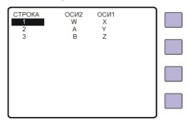
При обращении к оси **W** она будет выведена в первой строке экрана вместо оси **X**. При обращении к оси **A** она будет выведена во второй строке экрана вместо оси **Y**. При обращении к оси **B** она будет выведена в третьей строке экрана вместо оси **Z**.
