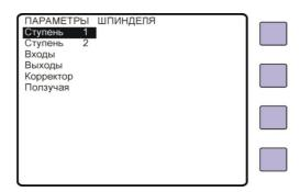
Направление движения по командам M3, M4 можно изменять знаками +/- в параметрах **Общие** параметры → Конфигурация выходов → Шпиндель. Для этого необходимо выбрать параметр *По часовой* или *Против часовой*, кнопкой необходимо переместить маркер в конец строки и нажать При каждом нажатии будет меняться знак полярности аналогового выхода для команд M3 и M4.
