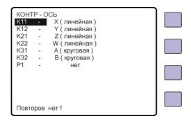
Перемещение маркера по строкам осуществляется кнопками 💌 и 📤. Название оси для данного контроллера последовательно изменяется с помощью кнопок 🔼 и 🛌. Рядом с осью, в скобках, выводится тип оси – линейная или круговая.
