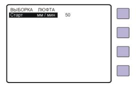
ВНИМАНИЕ: Функция выборки люфта включается для каждой оси индивидуально (см. *Параметры осей—Зоны Торможения—Эвыборка люфта - ВКЛ*). Осуществление механической выборки люфта возможно, если датчик положения стоит непосредственно на рабочем органе после механического редуктора, например линейный ЛИР-7 и т.п.
